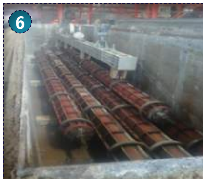
Perawatan Beton dengan Uap
