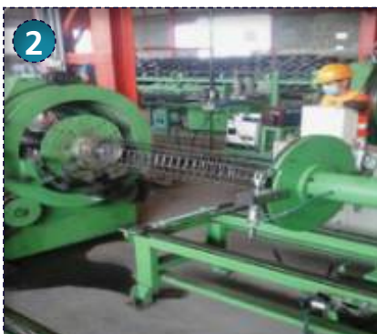
Perakitan/Pemasangan Tulang dan Asesoris
