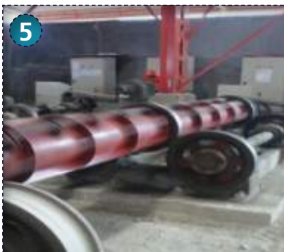
Pemadatan Beton dengan Mesin Spinning
