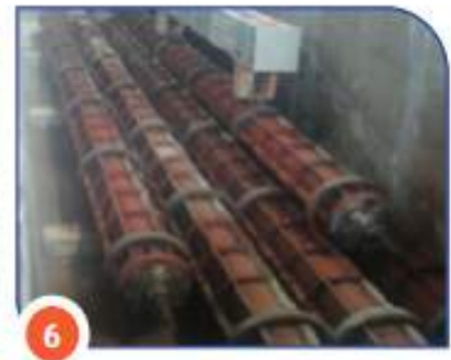
6 Perawatan Beton dengan Uap Steam Treatment of Concrete
