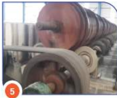
5 Pemasatan Beton dengan mesin Spinning Concrete Compaction with Spinning machine
