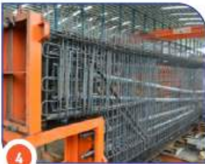
Pemasangan Dinding Cetakan Prefab Wall Mounting
