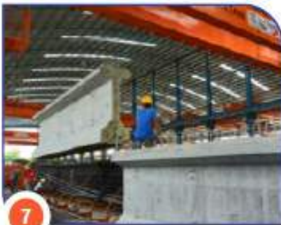
Pembukaan Cetakan Mold Opening
